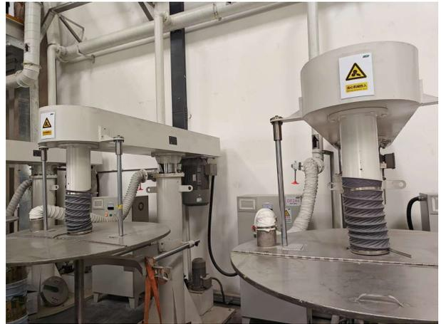
分散机废气收集
