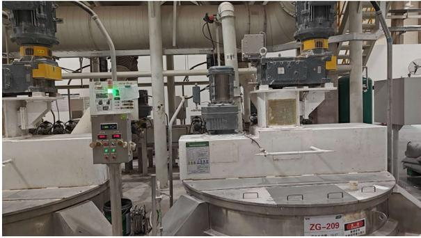
真石质感生产线投料工序废气收集
